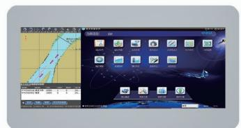
配备中海达HiMAX海洋测量软件，具备采集、导航和后处理功能，模拟水深和数字水深叠加、方便对真实水深数据的判读。
