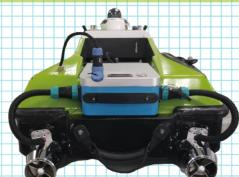
模块化设计，电子调速器与推进器高度集成，更换方便，易于维护保养。推进器与船底齐平，方便投放、浅滩作业和运输。
